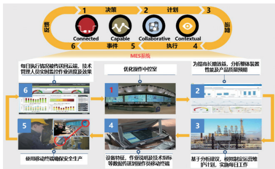
图 3-5：数字化生产管理系统运行架构图
